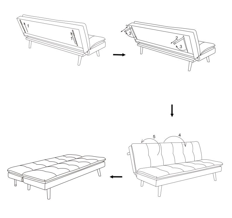
Le mécanisme type clic-clac permet 3 positions pour votre banquette (2 inclinaisons de dossier et une position allongée) Lors de la manipulation ne pas forcer sur le mécanisme et veiller à ce que les deux côtés du dossier soient enclenchés dans la même position pour chaque inclinaison. Pour cela une inclinaison lente et progressive est nécessaire. Pour une bonne stabilité du couchage, les pieds supplémentaires doivent être sortis et déployés.
