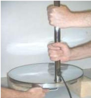
Vissez le tube sur la base et vérifiez que la sortie du câble se trouve sur l'arrière
