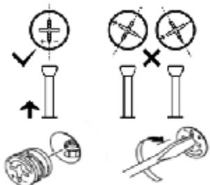
Avant de raccorder les excentriques, bien s'assurer que la position de départ est correcte avant d'insérer le boulon de connexion.
