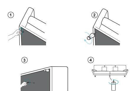
EVITER DE FORCER L'ASSEMBLAGE. RESERRER APRES UN MOIS D'USAGE.
